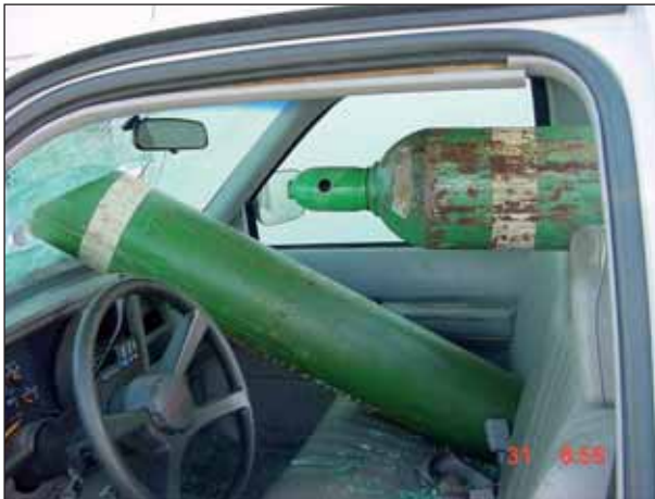
Následky nehody, kdy lahve nebyly zajištěny proti pohybu
