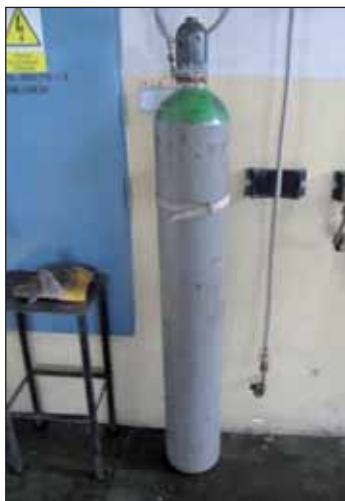
Příklad zajištění tlakové lahve proti pádu
