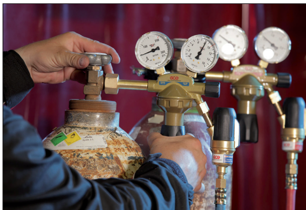
Ukázka redukčních ventilů u kyslíko-acetylenové svařovací soustavy
