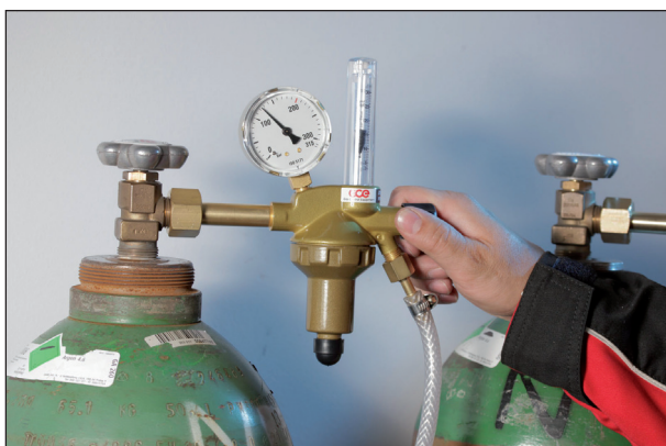
Lahvový ventil na technické plyny s redukčním ventilem
