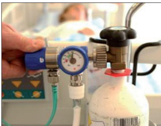
Lahvový ventil na medicínální plyny s redukčním ventilem
